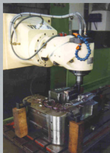
Insertos en acero templado, matrices inyección cajas de cambio Fiat.
