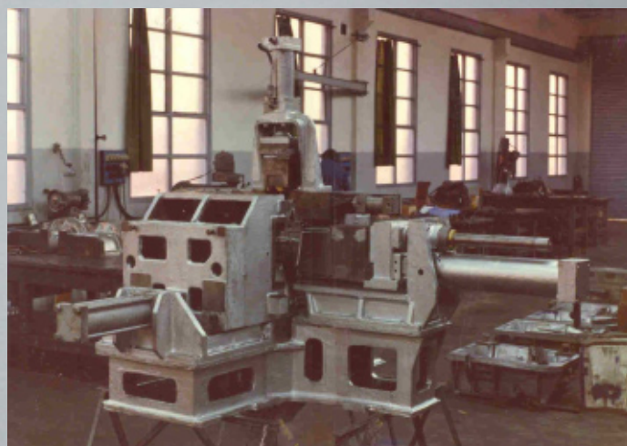
Coquilla y banco coquillero para Caja de cambios Dodge.
