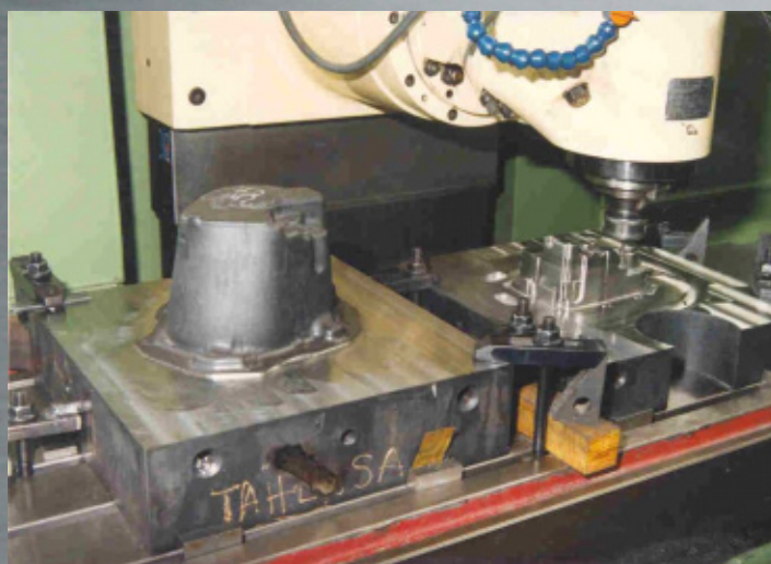
Insertos en acero templado, matrices inyección cajas de cambio Fiat.
