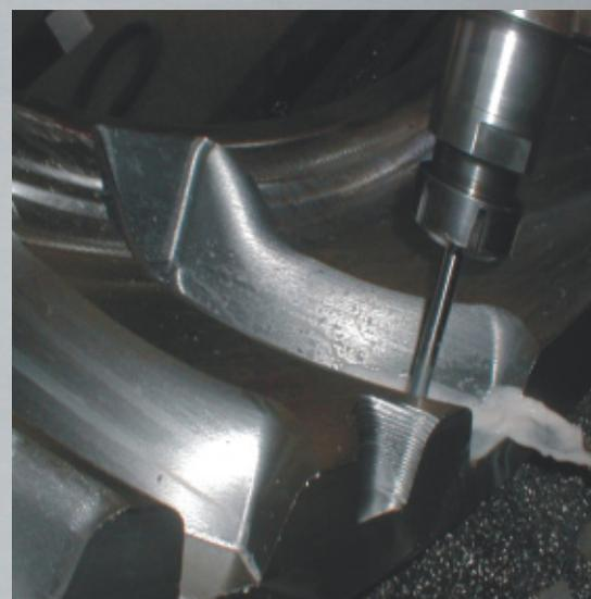
Detalle de mecanizado de molde 380/85R24
